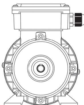
Eksempel på tegning af motor-model MS uden flange med B3 fod.
