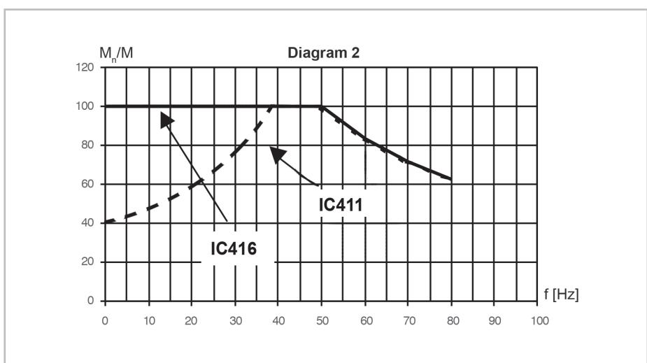
\* Bemærk at det reguleringsteknisk med en almindelig frekvensomformer ikke er muligt at kontrollere motorens moment og rundløb mellem 0 og ca. 5 Hz.
